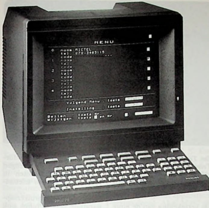
Compact en gebruiksvriendelijk is de videotex terminal van Philips (NMS 6302) met geïntegreerd toetsenbord en auto-dial modem (V.23).
